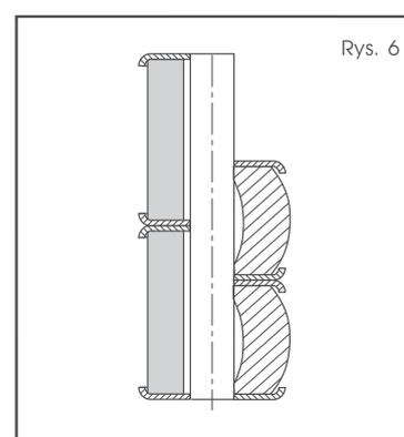
Zestaw sprężyn ADIPOL i ULTRAFLEX przedzielonych podkładkami metalowymi.
