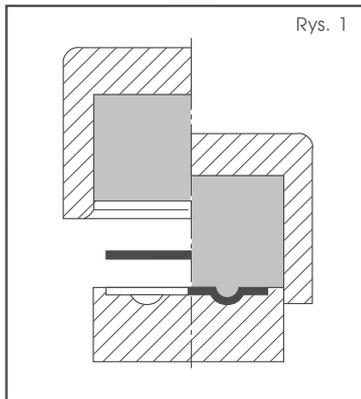
Rysunek zastosowania matrycy ULTRAFLEX. Wkład musi być umieszczony w jednolitej stalowej konstrukcji. Zalecane jest użycie wolnych pras i wysokich tonaży z uwzględnieniem wymiarów obrabianego materiału.
