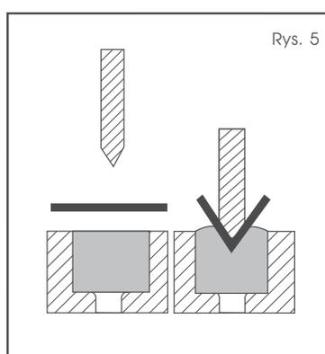
Gięcie blachy na płytach elastomerowych (zalecany przy możliwym uszkodzeniu powierzchni materiału np: miedź, aluminium, stal nierdzewna, itp.).
